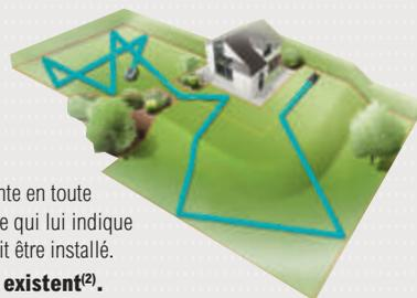
Le robot tondeuse réalise la tonte en toute autonomie grâce au câble guide qui lui indique les limites du terrain, et qui doit être installé.
